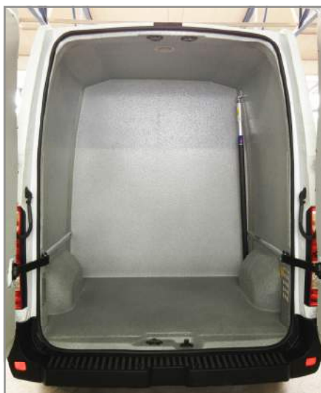
Zweifache Teilung des Laderaums zu einem 2-Kammer-Laderaum
