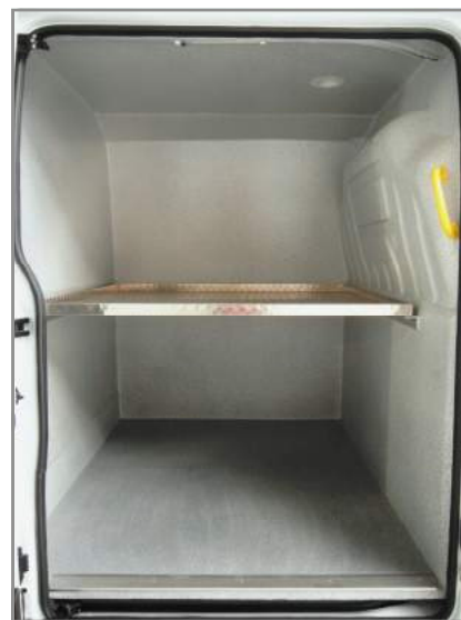
Zweifache Teilung des Laderaums zu einem 2-Kammer-Laderaum
