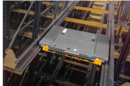
Shuttle-Kompaktlagersystem mit UPC (bis 1.500 kg)
